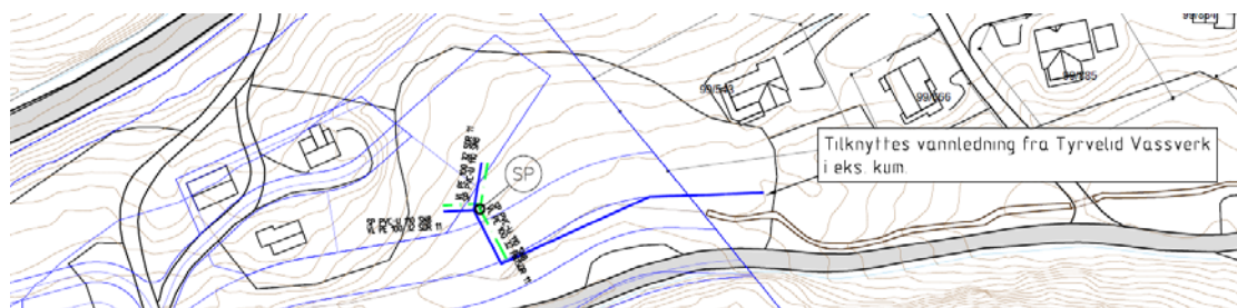
Bilde 2: Bildet viser tilkoblingspunkt for vann og spillvann for tomt T5 og T6. Her tenker man seg å knytte til kommunal spillvannsledning med en gren. Vannet er tenkt tilknyttet i eksisterende vannkum.
